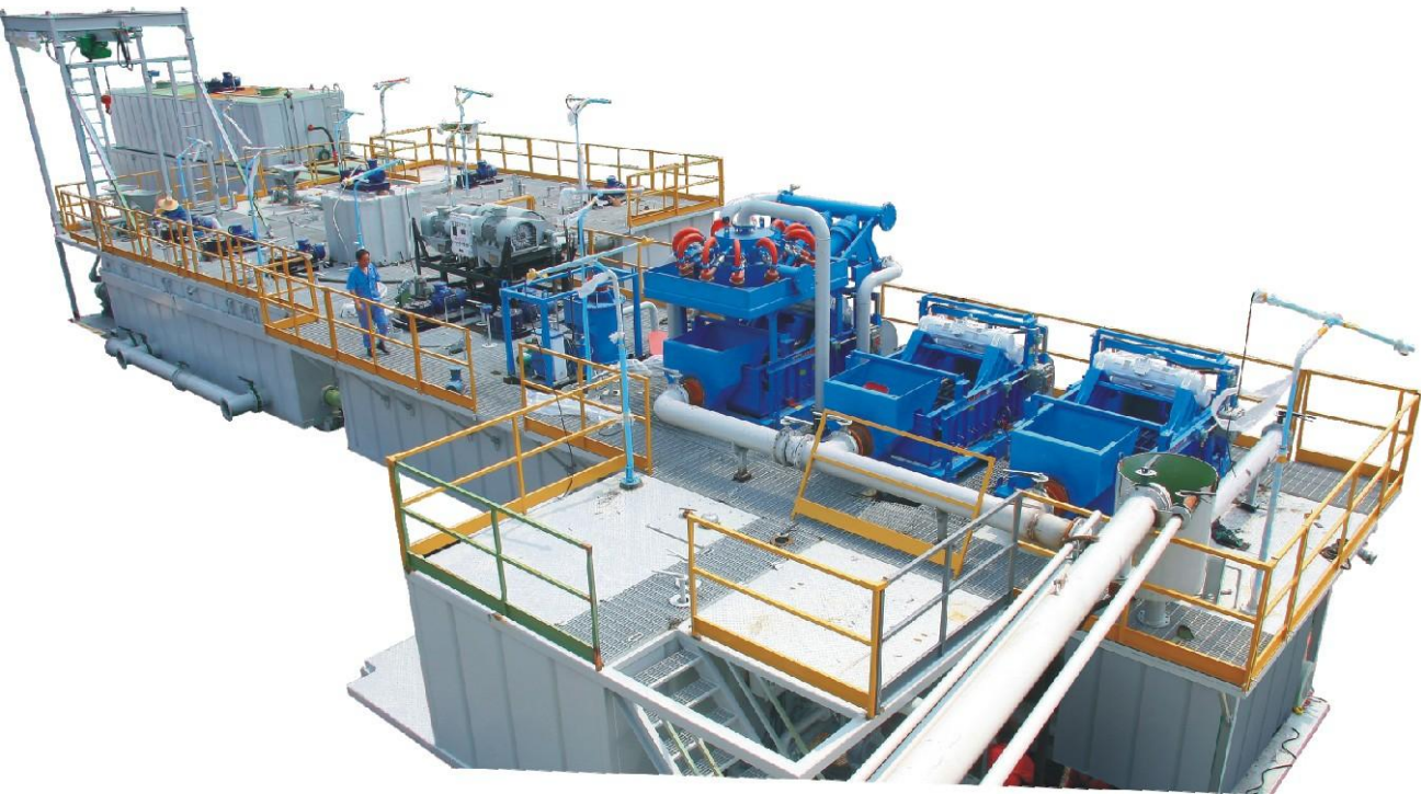
Циркуляционная система очистки бурового раствора
